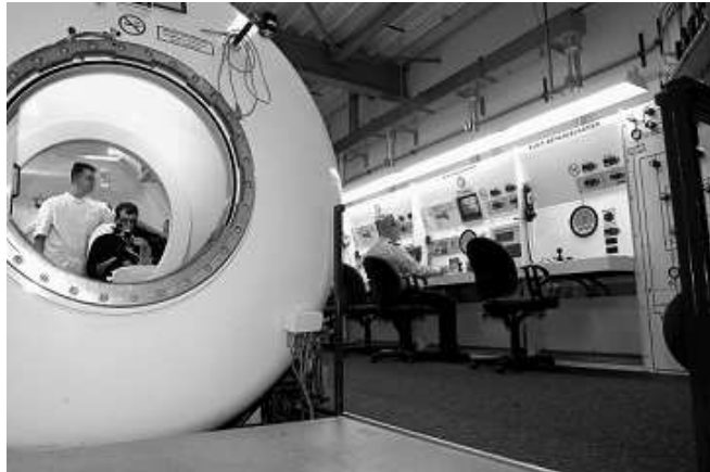
Figuur 10: Multiplace recompressiekamer
